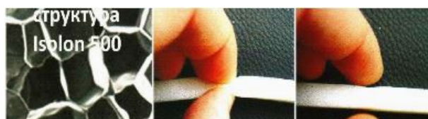
Структура Isolon 500 и Isolon 300 при нагрузках восстанавливается.
