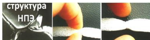
Структура НПЭ любой марки при нагрузках при нагрузках не восстанавливается.
